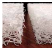
ブレスエア 左がハード 右がソフト 94%が空気で できている
