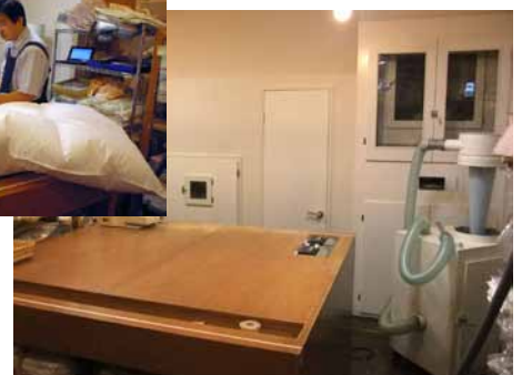
羽毛の量を1g単位で計量し除塵する新型マシン
